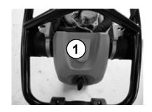
Sacar el cartucho del filtro de aire (1) de la carcasa. Limpiar el cartucho del filtro de aire (1), reemplazar en caso de deterioro o extrema suciedad.
